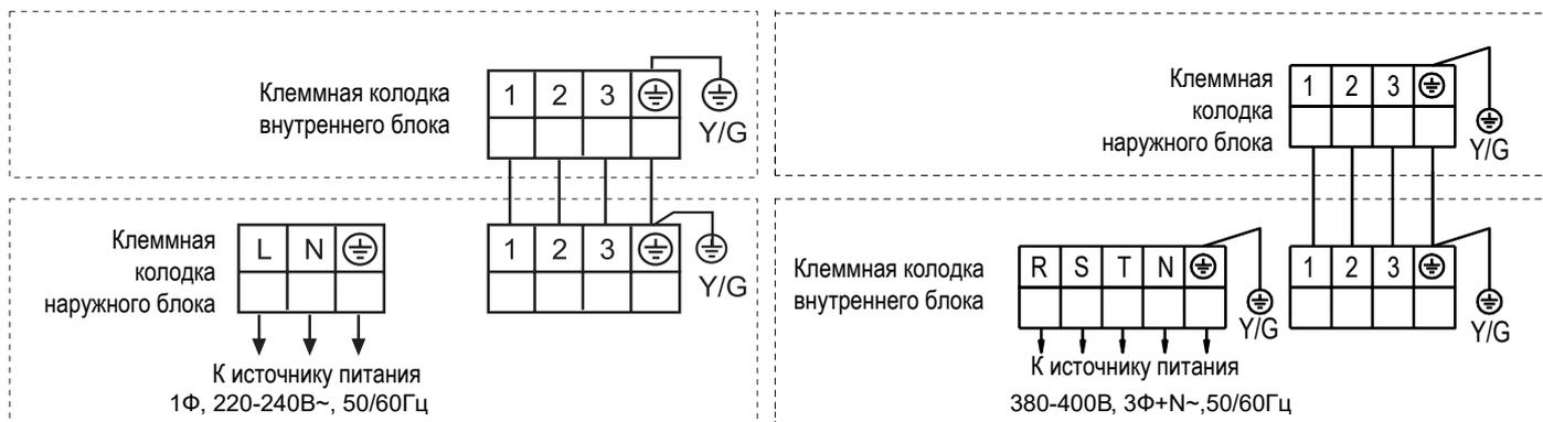
Тип межблочного коммуникационного кабеля: ПВС(ВВГ) 4 x 2,5 мм<sup>2</sup> (кабель импортной маркировки H05RN-F4G 2.5мм<sup>2</sup>).
