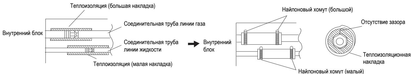
При использовании дополнительной соединительной трубы теплоизоляцию следует накладывать таким же способом как указано выше.
